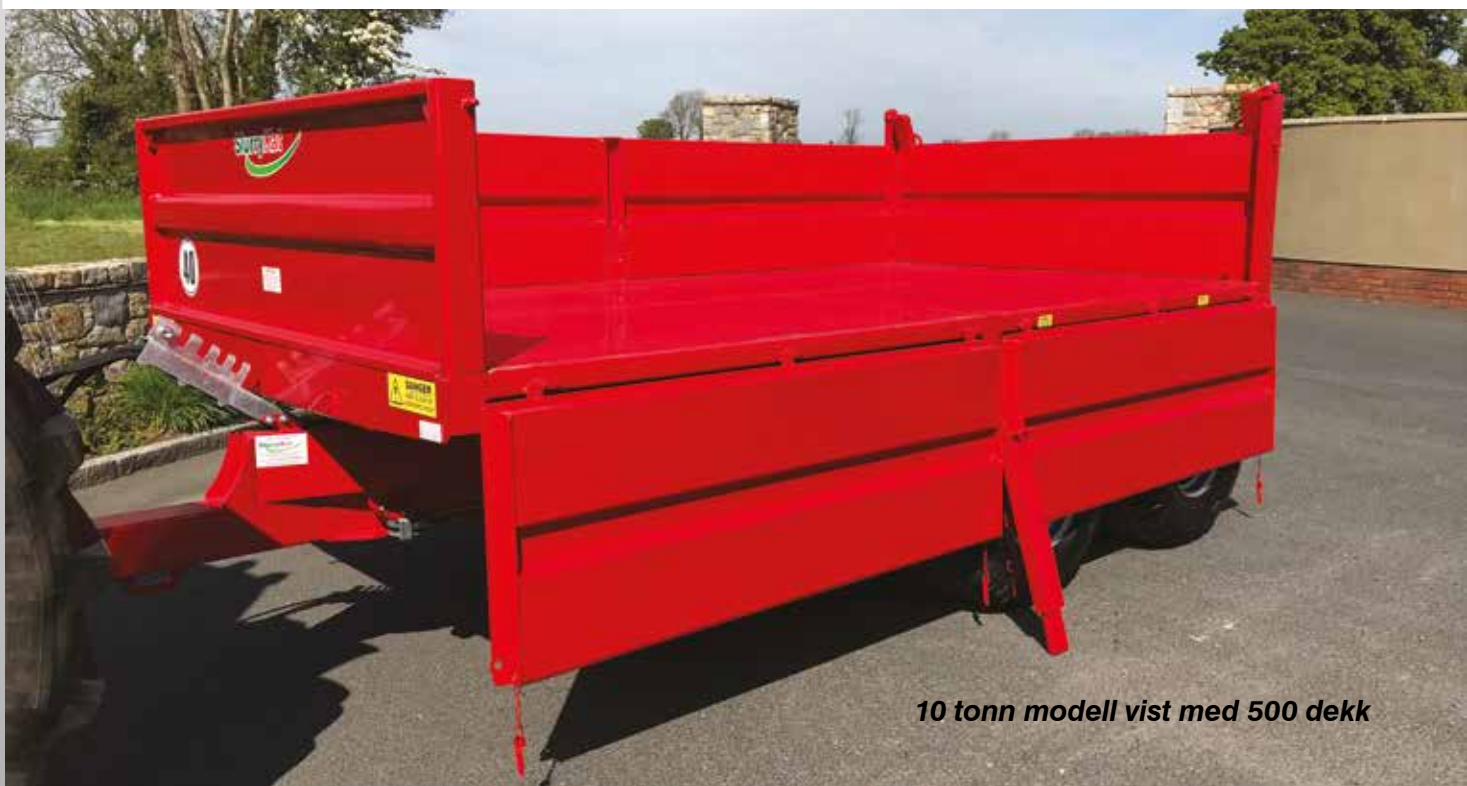
12 tonn modell med 550/45R22,5 dekk og valgfri rundballeforlenger
