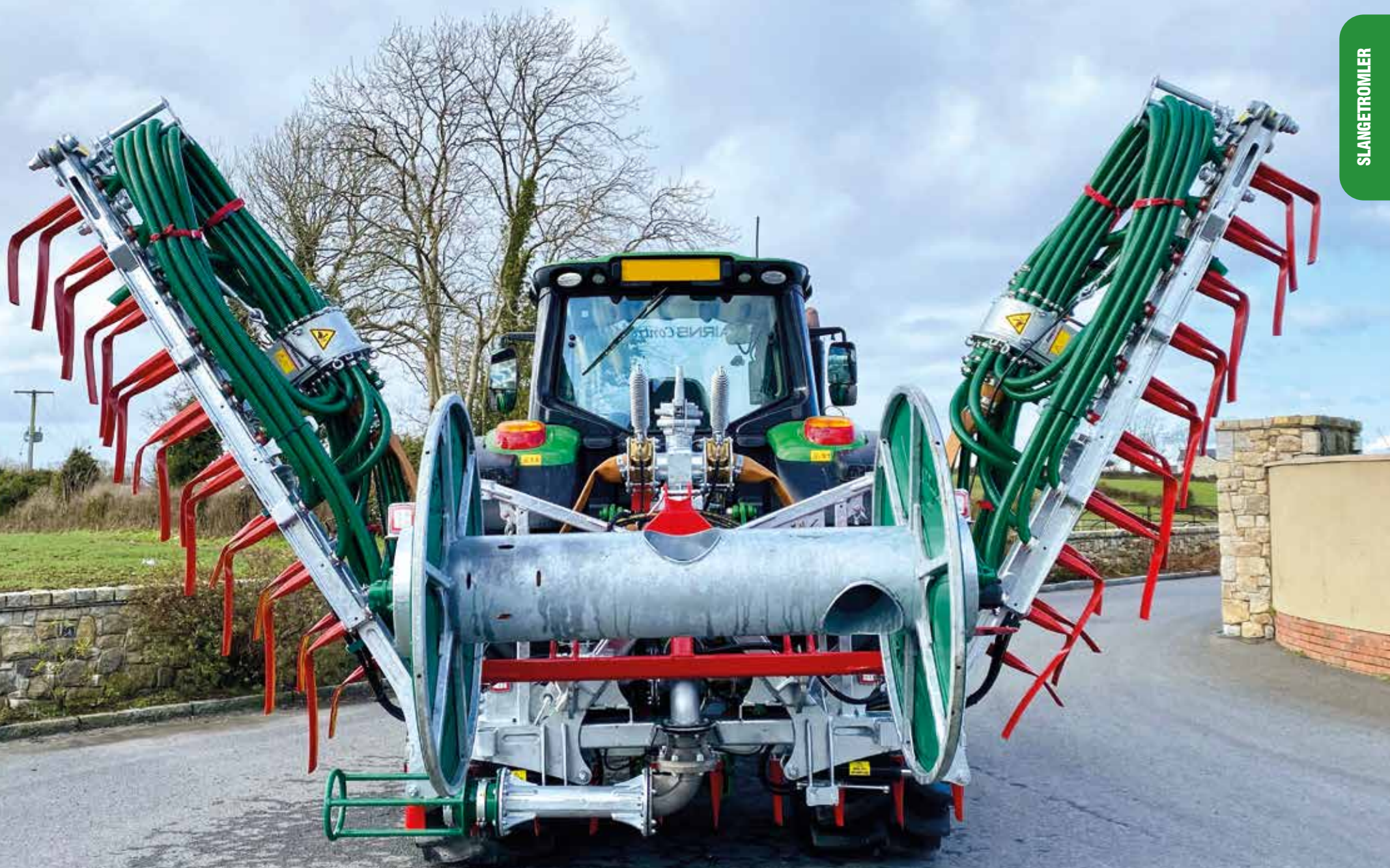
800 m trommel montert på 12 m spredebor
