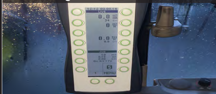
Skjerm og fjernkontroll med berøringskjerm for montering i traktor
