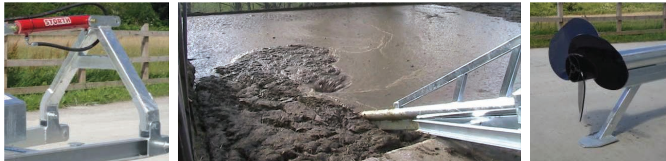
Og firkantbjelke for tung belastning styrker blanderøret
